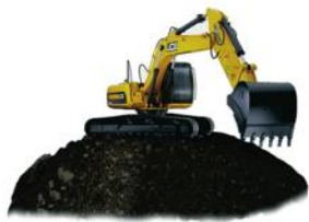
Разработка грунта под фундамент
